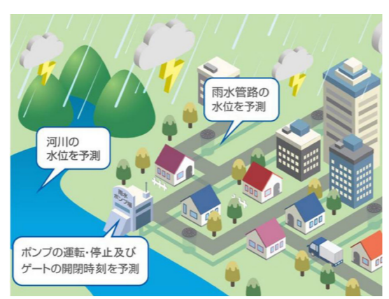
本実証実験にて構築したシステムのイメージ図
