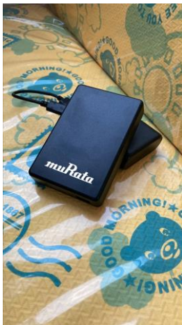
車室内モニタリングシステムで使用する Wi-Fi センサ
